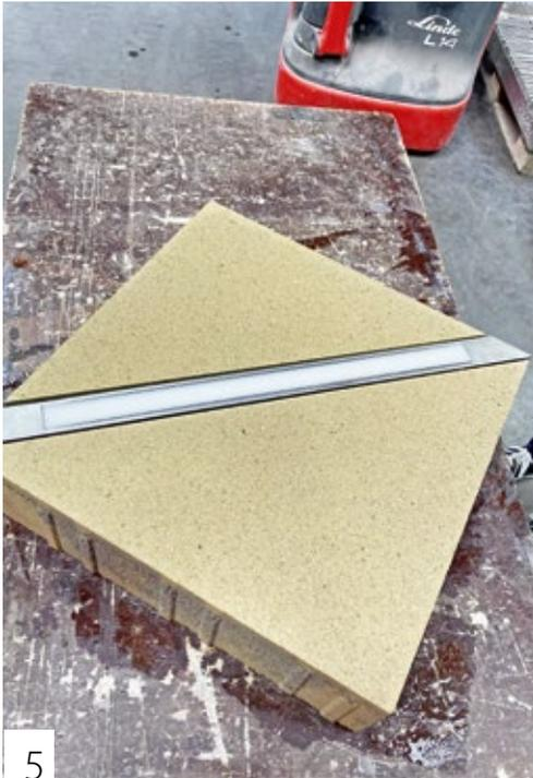
Quartier bilden, sondern eine gewollte Spannung erzeugen, um die Menschen anzuregen, diesen öffentlichen Raum aktiv zu erkunden. Zusätzlich besitzt jede vierte Platte eine Sinus-Rillierung und erzeugt optische Effekte mittels veränderter Lichtbrechung. Die beim Verlegen eingelegten Kreuzfugenanker stabilisieren die Platten gegen horizontale Schubkräfte. Die Anker, die bis in die Tragschicht ragen, schützen zudem vor Verschiebungen.
