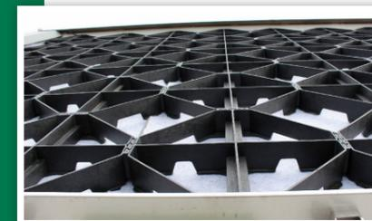
Das auf dem Steildach verlegte Georaster schließt unten elegant mit dem Traufprofil TRP 140 ab. Gehalten wird das Ganze durch Schubhalter auf den Dachsparren.
